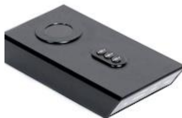
Figure 12. Dispositif portable de NIRS applicable sur un muscle.
